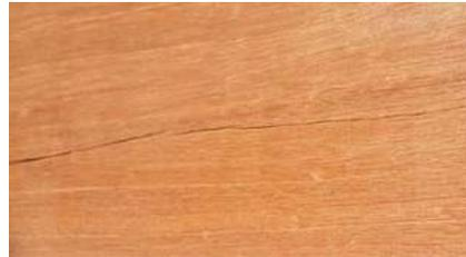
**Trockenrisse:** Das Quellen und Schwinden findet im Holz nicht gleichmäßig statt. Dadurch können sogenannte Trockenrisse entstehen. Sie beeinflussen in der Regel nicht die statischen Eigenschaften und die Festigkeit des Holzes und sind daher zu tolerieren.
